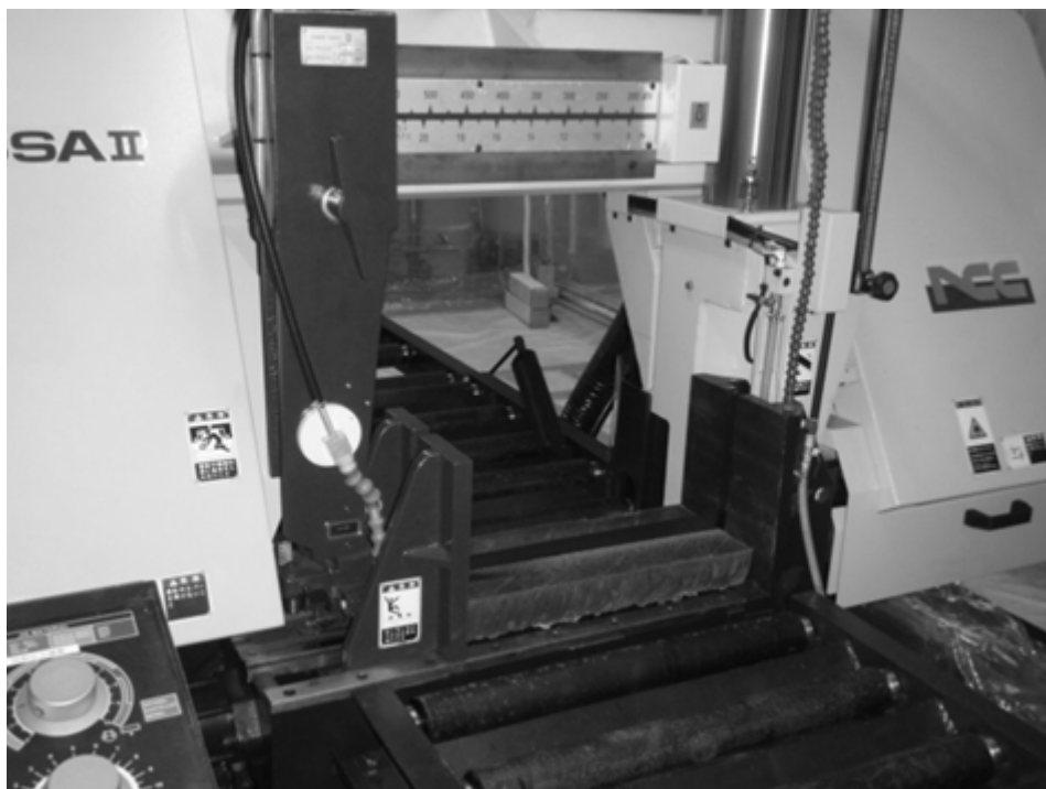
図 4.4.2-5 大型バンドソーによる解体
