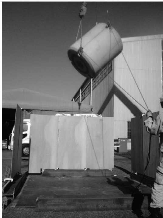
図 6.2.3-1 蓋式コンクリート容器の落下試験
