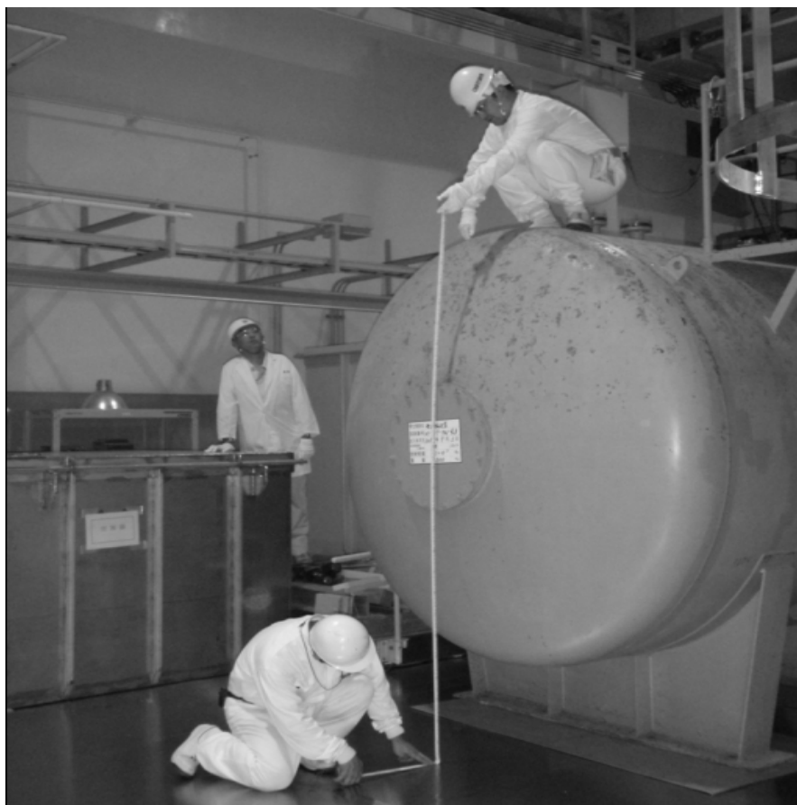
図 4.4.2-2 廃液タンクの入受検査（外観寸法測定）
