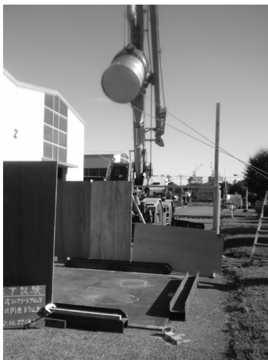
図 6.2.3-2 蓋式コンクリート内巻ドラム缶の落下試験
