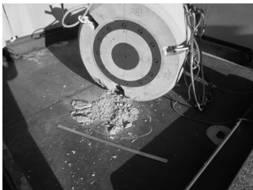
図 6.2.3-3 落下試験後の蓋式コンクリート容器
